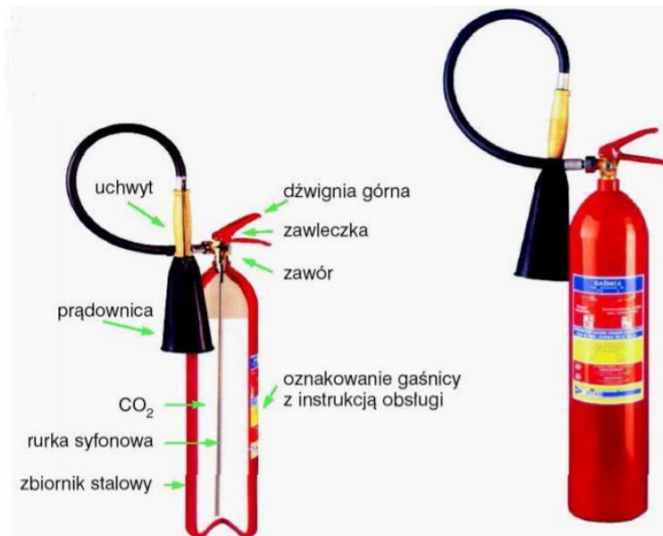
Zdjęcie Budowa gaśnicy śniegowej
