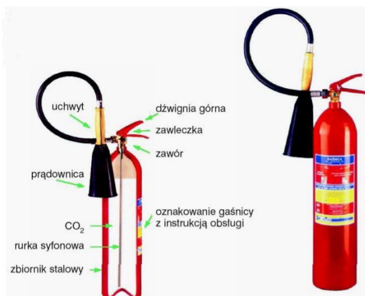
Zdjęcie Budowa gaśnicy śniegowej
