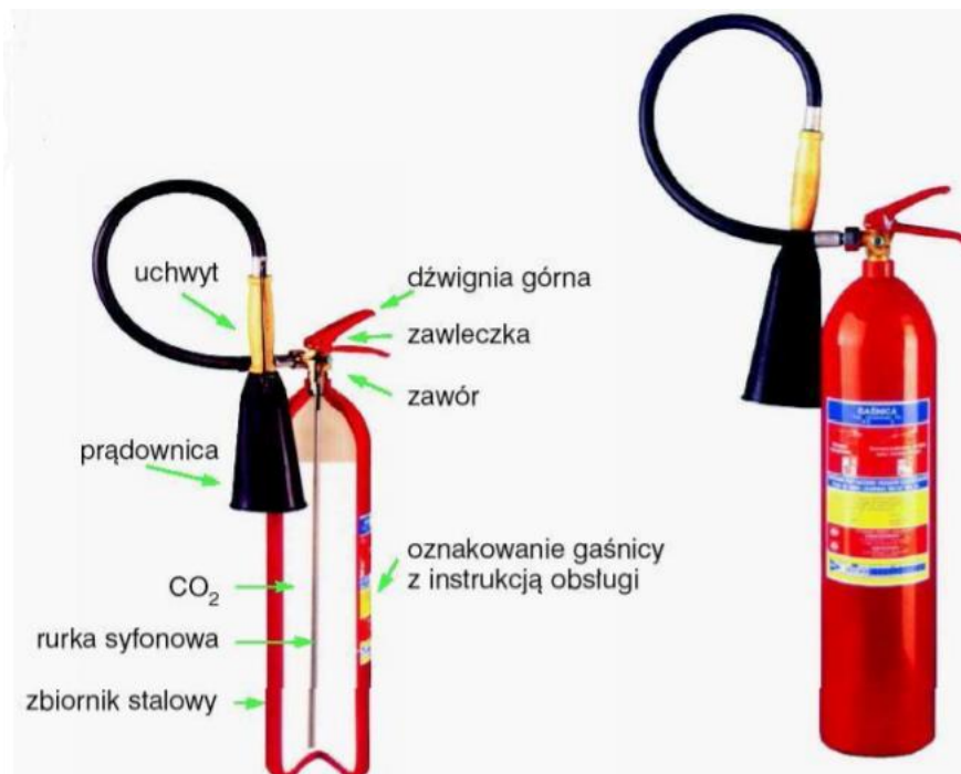
Zdjęcie Budowa gaśnicy śniegowej
